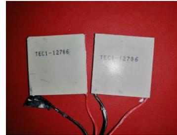
Fig. 3. Celda Peltier TC1-12706
