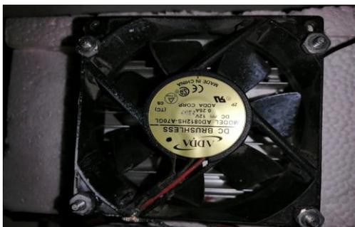
Fig. 15. Ensamble de ventilador a disipador
