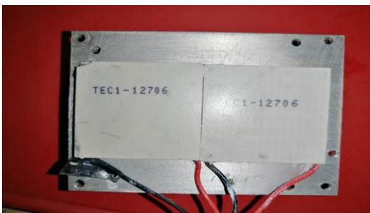
Fig. 14. Ensamble de celdas Peltier al disipador
