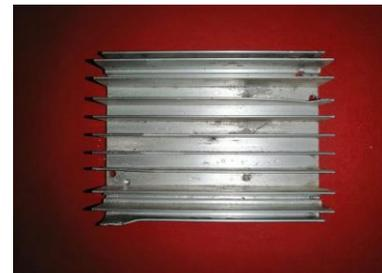
Fig. 5. Disipador de calor hecho de aluminio
