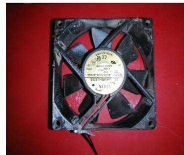
Fig. 4. Ventilador de 12 voltios de corriente continua
