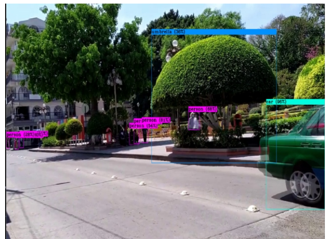
Fig. 6. Prueba de detección YOLOv4 con falso positivo en fotograma Fuente: Elaboración propia
