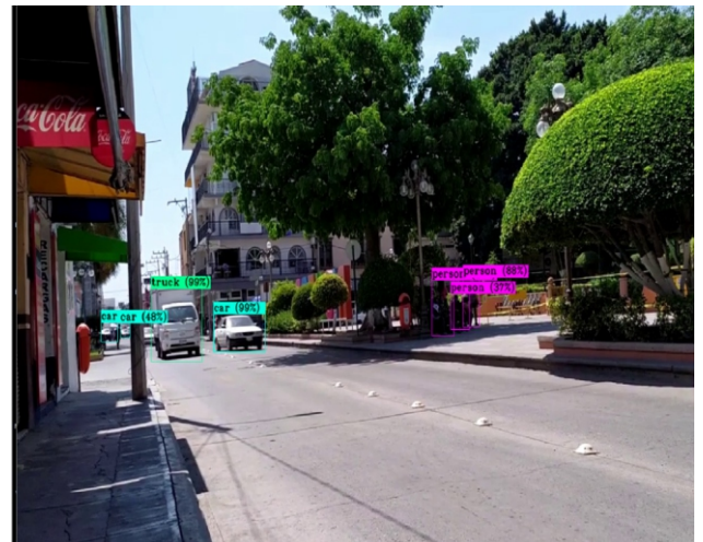
Fig. 5. Prueba de detección YOLOv4 con verdaderos positivos en fotograma. Fuente: Elaboración propia
